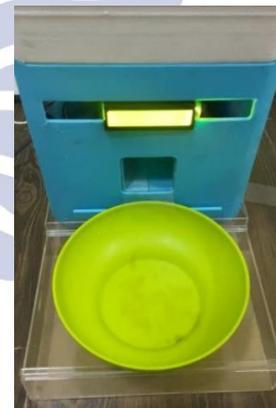
Gambar 8. Penempatan Wadah Pakan di Atas *Load Cell*
