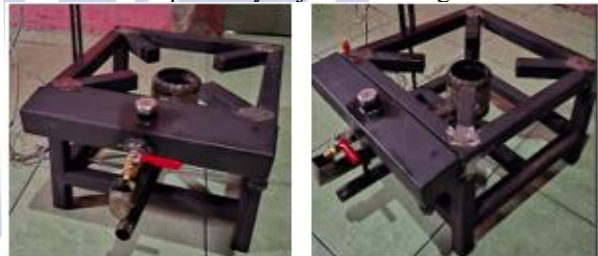
Gambar 3. Hasil Manufaktur Kompor Minyak jelantah
