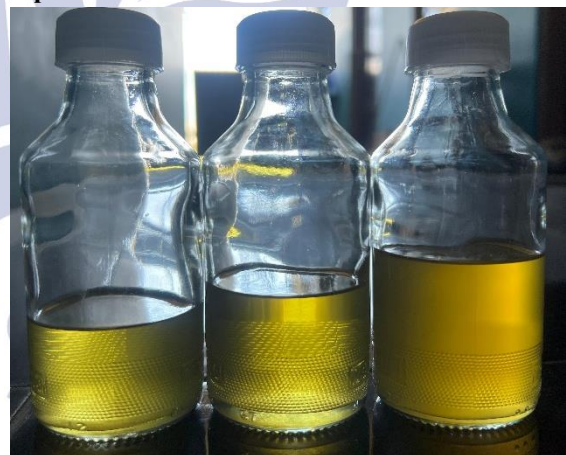
Gambar 3. Minyak pirolisis LDPE ( Low Density Polyethylene ) a) pembakaran reaktor temperatur 275°C, b) pembakaran reaktor tempertur 300°C, c) pembakaran reaktor temperatur 350°C
