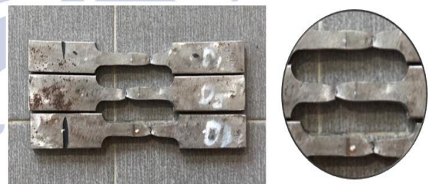
Gambar 5. Patahan Spesimen Uji Tarik
