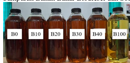
Gambar 3. Bahan bakar solar (B0), biosolar minyak kelapa sawit (B10, B20, B30, dan B40) dan biodiesel (B100)
