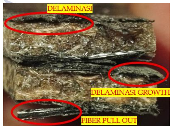
Gambar 2 Foto Makro Setelah Uji Tarik
