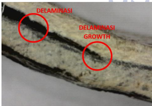
Gambar 2 Foto Makro Uji Bending
