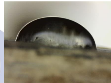
Gambar 3 Foto Setelah Uji Penyerapan Air
