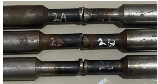
Gambar 9. Hasil Pengujian Tarik Kecepatan 560 rpm
