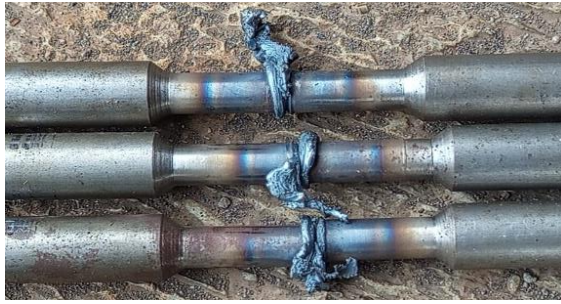
Gambar 6. Hasil Pengelasan Kecepatan Putaran 360 rpm
