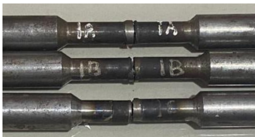
Gambar 8. Hasil pengujian tarik kecepatan 360 rpm
