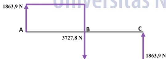
Gambar 22. Diagram Gaya Geser Lengan Penghubung
