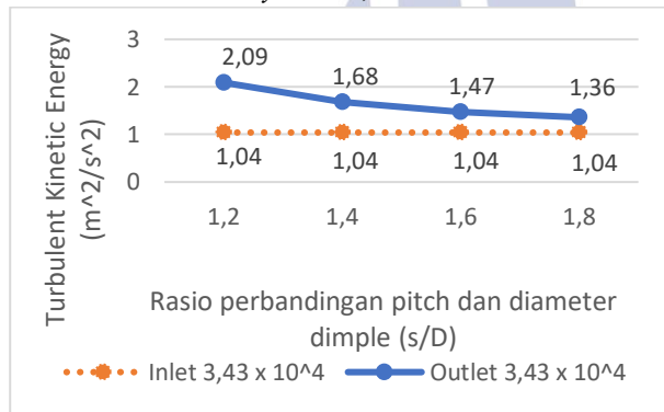
Gambar 22. Kurva turbulent kinetic energy average di outlet pada bilangan Reynolds 3,43 \times 10^4 di masing-masing rasio s/D
