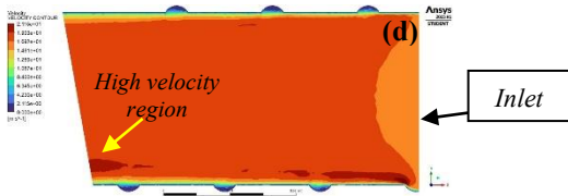
Gambar 12. Velocity contour pada rasio s/D (a) 1,2; (b) 1,4; (c) 1,6; dan (d) 1,8 pada bilangan Reynolds 3,43 \times 10^4
