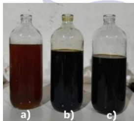
Gambar 3. Hasil Minyak Pirolisis Variasi Komposisi Bahan Baku PP:PS a) 100:0, b) 80:20, c) 60:40
