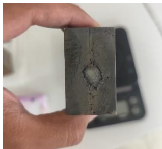
Gambar 2. Pengamatan Korosi pada Baja Karbon AISI 1020
