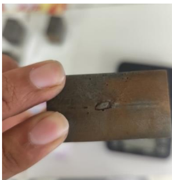
Gambar 3. Pengamatan Korosi pada Baja Karbon ASTM A36
