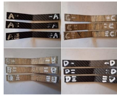
Gambar 4 Material Bending Sesudah Diuji
