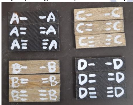
Gambar 7 Material Impact Sebelum Diuji
