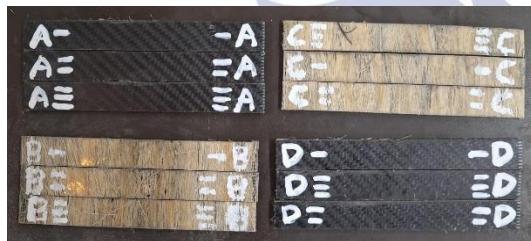
Gambar 3 Material Bending Sebelum Diuji
