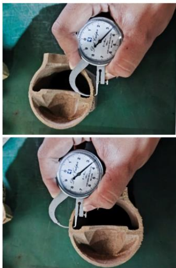
Gambar 9. Pengukuran Potongan Body Valve
