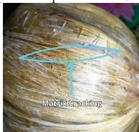
Gambar 9 Foto Matrix Cracking Pada Helm Safety
