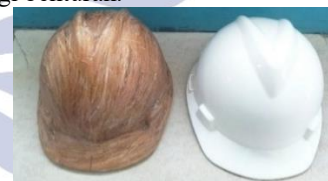
Gambar 8 Hasil Fabrikasi Helm Safety Komposit Sabut Kelapa
