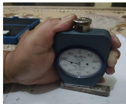
Gambar 2 Proses pengujian kekerasan Shore D pada spesimen komposit
