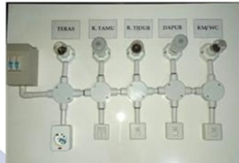
Gambar 5. Alat Peraga Instalasi Listrik Satu Phase
