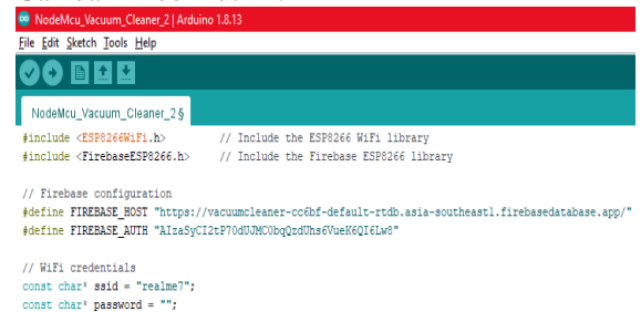
Gambar 11 Proses Menghubungkan Program Mikrokontroler dengan Firebase
