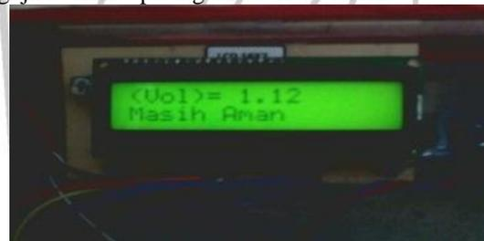
Gambar 9. Pengujian Sensor Gas Pada Kondisi Aman
