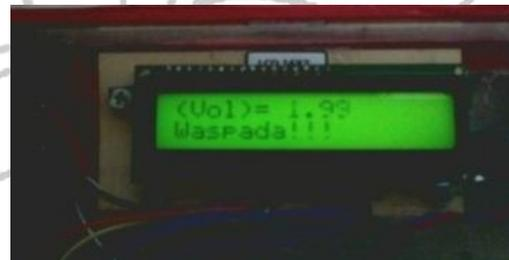
Gambar 24 Pengujian Sensor Gas Pada Kondisi Waspada
