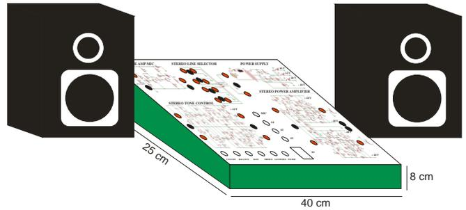
Gambar 3. Gambar Rancangan Desain Trainer Audio Amplifier Stereo
