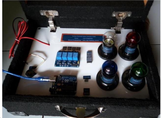
Gambar 5 *Trainer* perintah suara berbasis Arduino UNO tampak dari depan ketika dibuka
