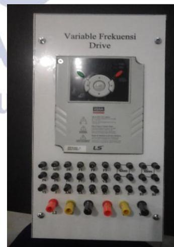
**Gambar 4.** Hasil Trainer Pengaturan Kecepatan Motor Listrik Menggunakan *Variable Frekuensi Drive*.
