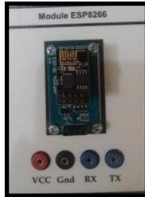
Gambar 6. Modul ESP8266
