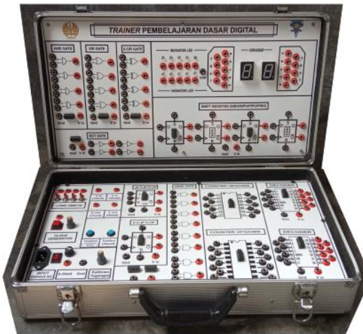
Gambar 4. Tampilan Trainer Pembelajaran Dasar Digital Tampak Depan (saat dibuka). P=52cm x L=28,5cm (lebar tiap layer) x T=12cm).
