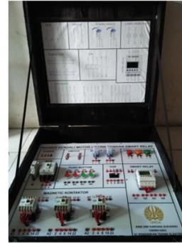
Gambar 3. *Trainer* Kendali Motor Listrik dengan *Smart Relay*.
