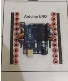
Gambar 5. Tampilan Arduino Uno . (Sumber: Dokumen Pribadi)
