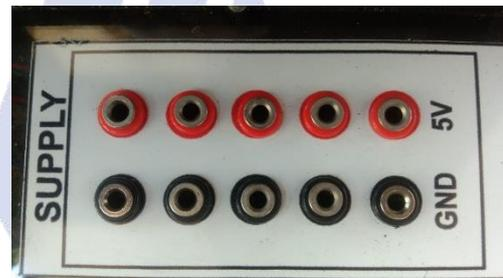
Gambar 10. Power Supply DC 5V pada board trainer
