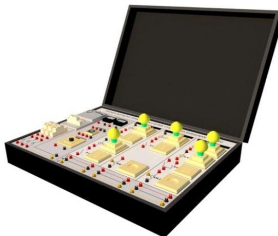
Gambar 3.2. Tampilan Tampak Samping Desain *Trainer* Instalasi Penerangan Listrik 1 Fasa
