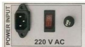
Gambar 10. *Input* 220V AC pada *board trainer*
