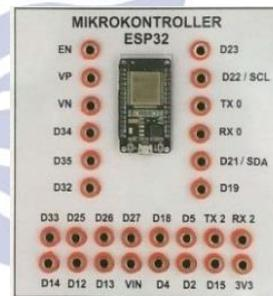
Gambar 5. Papan *board* mikrokontroler ESP32 pada *trainer* (Sumber: Dokumen Pribadi)
