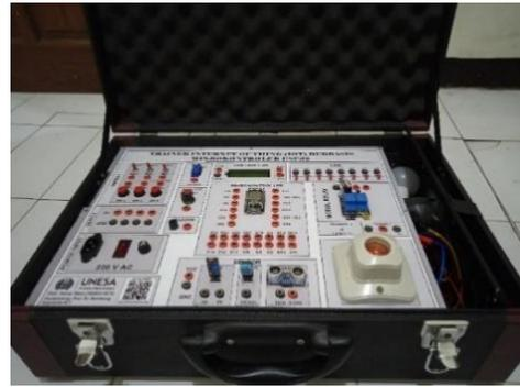
Gambar 4. Bagian dalam *trainer internet of things* (IoT) berbasis mikrokontroler ESP32 (Sumber: Dokumen Pribadi)
