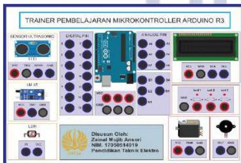
Gambar 2. Desain *Trainer* Mikrokontroler Arduino Uno
