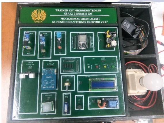
Gambar 4. *Trainer* Kit Mikrokontroler Nodemcu Esp32 Berbasis *IoT*.
