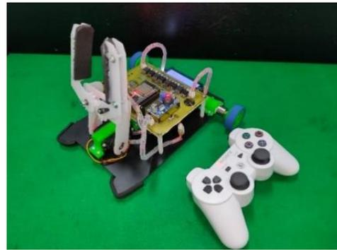
Gambar 6. Bentuk *Transporter Robot* dan controller *Dualshock 3*.
