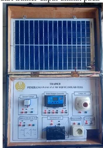
Gambar 2. Trainer Penerangan Jalan Umum Solar Cell
