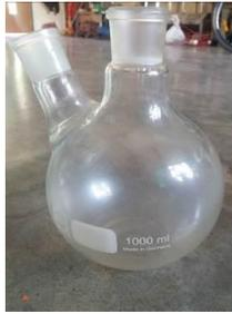
**Gambar 4. Labu Distilasi Kapasitas 1 Liter**
