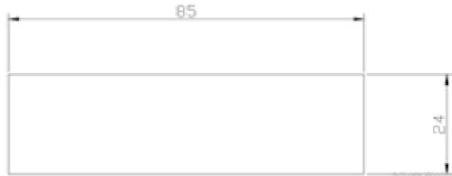
Gambar 1. Ukuran desain spesimen
