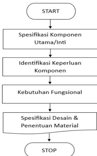
Gambar 3. Diagram Alir Tahapan Desain Trainer Kontrol Relay
