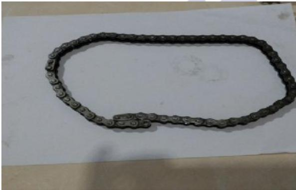
Gambar 4. Panjang Rantai 532 mm Untuk 49 rpm
