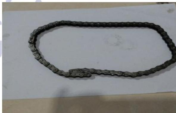
Gambar 2. Panjang Rantai 525 mm Untuk 36 rpm
