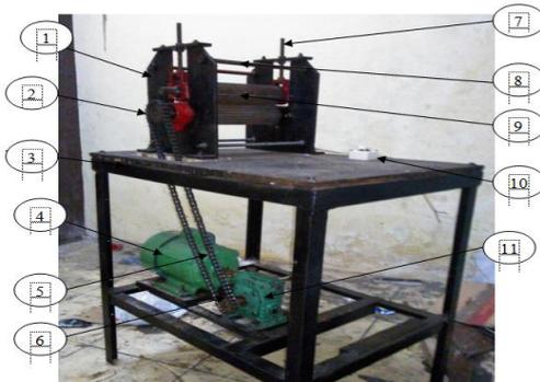
Gambar 9. Rancang Bangun Mesin Pengerol Plat Bergelombang
