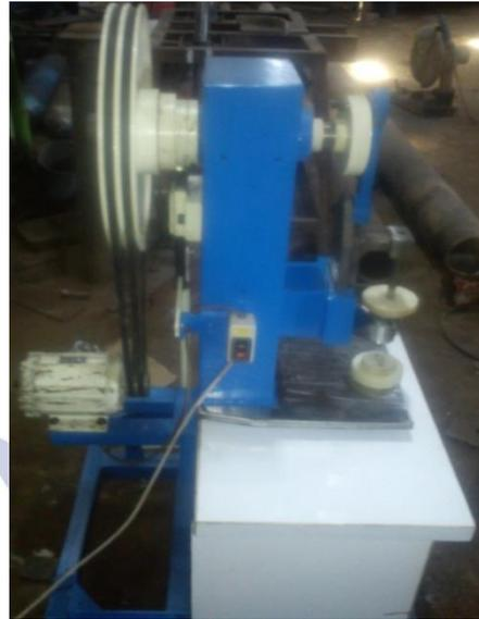
Gambar 5. Hasil Mesin Pengupas Kulit Nanas Semi Otomatis
