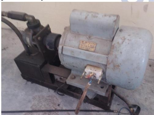
Gambar 3. Kondisi Pompa dan Motor
