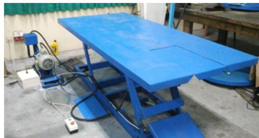
Gambar 10. *Bike Lift* Sudah di Reinstal
