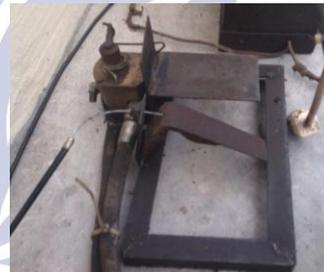
Gambar 14. Pedal Pengembali *Bike Lift* Lama
