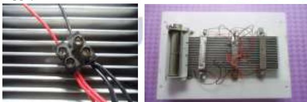
Gambar 17. Rangkaian Seri Pada Kelistrikan *Thermo Electric Cooler (TEC)*
