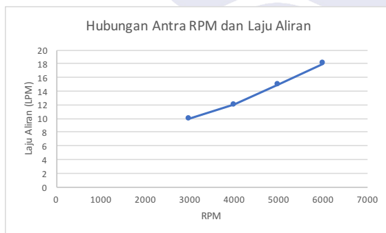
Gambar 7 Grafik hubungan antara RPM dan laju aliran pada radiator single ply dan double ply .
