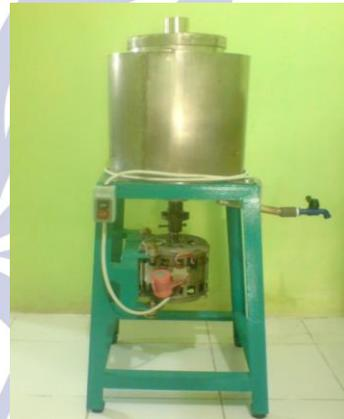
Gambar 10. Mesin Penggiling Daging Yang Selesai Dirakit
