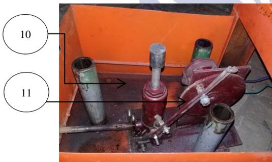
Gambar 10. Penempatan Hydraulic Jack Electric
