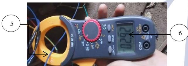
Gambar 12. Uji Arus Menggunakan Tang Ampere.
