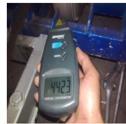
Gambar 2. Uji Kecepatan Rpm Maksimal Tanpa Beban Pada Motor Penggerak
