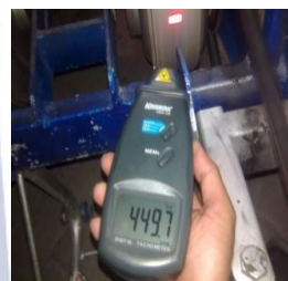
Gambar 2. Uji Kecepatan Rpm Maksimal Tanpa Beban Pada Motor Penggerak
