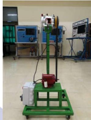
Gambar 6. Rangka media pembelajaran cutting *compressor ac* mobil tipe axial kerja tunggal
