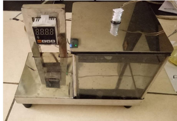
Gambar 7. Hasil Rancang Bangun Alat Uji Pour Point
