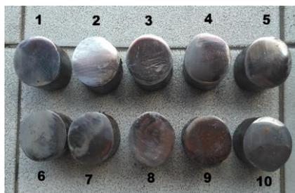
Gambar 4. Permukaan Baja ST 41 Hasil Dari Proses Polishing
