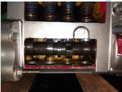
Gambar 8. bagian yang di cutting dan terlihat noken AS
